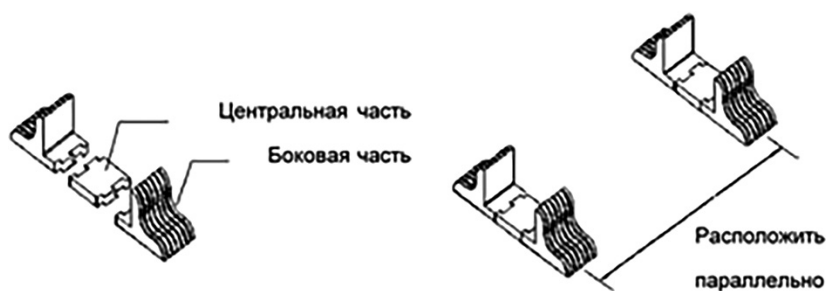
Рис. 2. Сборка и расположение опор
