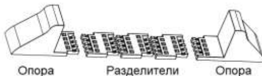
Рис.4-2 Установка опор с разделителями
