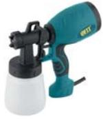
500 Вт; 800 мл/мин; 40 дин/сек; 2,5 мм; 800 мл; 2,3 А; 1,2 кг; коробка. Технология распыления HVLP обеспечивает высокую эффективность переноса материала на окрашиваемую поверхность; съемный/разборный узел распыления, регулировка формы факела, регулировка расхода материала, компрессор турбинного типа, мощный коллекторный двигатель; система фильтрации воздуха, широкий выбор применяемых материалов, резиновые вставки.
