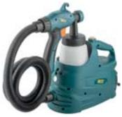
650 Вт; 400 мл/мин; 80 дин/сек; 2 мм; 800 мл; 2,9 А; 2,2 кг; коробка. Технология распыления HVLP обеспечивает высокую эффективность переноса материала на окрашиваемую поверхность. Переносной нагнетатель, облегченный распылитель, брызгозащитный выключатель, специальный плечевой ремень, регулировка формы факела, регулировка расхода материала, компрессор турбинного типа, мощный коллекторный двигатель, система фильтрации воздуха, широкий выбор применяемых материалов.
