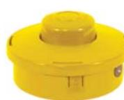
Для различных триммеров с посадочной резьбой шпинделя М10. Полуавтоматический (ударный) сброс изношенной лески. Усиленные пропускные проушины. D=115 мм; Частота вращения: 10000 об/мин; леска 2-2,4 мм; Материал: полиамид, металл. Упаковка: п/э пакет с картонным подвесом.
