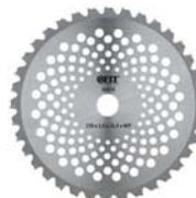
Для скоса и измельчения травы, кустарников и тонких стволов деревьев. Посадочный диаметр 25,4 мм. Толщина режущей кромки 2,0 мм. Материал: инструментальная сталь, карбидные режущие вставки. Упаковка: картонный конверт.
