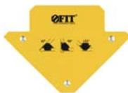
Тип «стрелка». Для фиксации металлических деталей при сварке, пайке и сборке конструкций под углами 45°, 90°, 135°. Для работы с круглыми и прямоугольными металлическими трубами, полосомами, уголками, профилями, листовым металлом и т.д. Материал: инструментальная сталь, ферритовый магнит. Упаковка: блистер.
