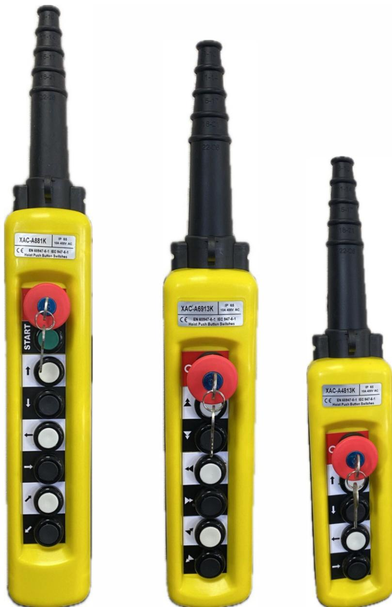
**Посты кнопочные серии ХАС** используются для дистанционного управления с пола электрических талей с односкоростными и двухскоростными электродвигателями в электрических цепях управления с напряжением до 220В постоянного тока и до 660В переменного тока частотой 50 и 60 Гц.
