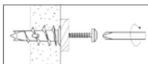
Установите KLA с помощью отвертки. Закрепите материал шурупом.
