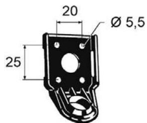
Кронштейны для крепления анкерных зажимов РС63 или других. Кронштейны изготавливаются из изоляционного материала с высокой степенью устойчивости к механическим, природно-климатическим воздействиям и ультрафиолетовому излучению. Допустимая нагрузка 2 кН. Крепятся с помощью крепежной ленты IF 207 или IF 107 или болта М16 или 4-х шурупов диаметром 5мм.
