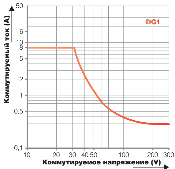
Диаграмма 2. Максимальная способность коммутации для постоянного тока – резисторная нагрузка (2 переключающих контакта)
