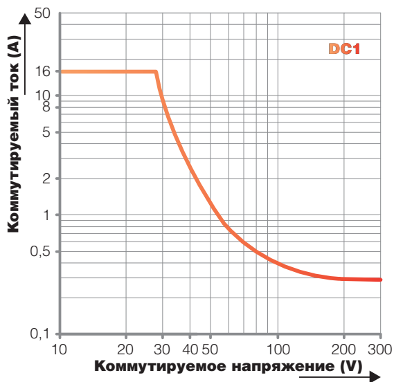
Диаграмма 1. Максимальная способность коммутации для постоянного тока – резисторная нагрузка (1 переключающий контакт)
