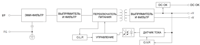
Рисунок 4. Принципиальная схема блока питания.
