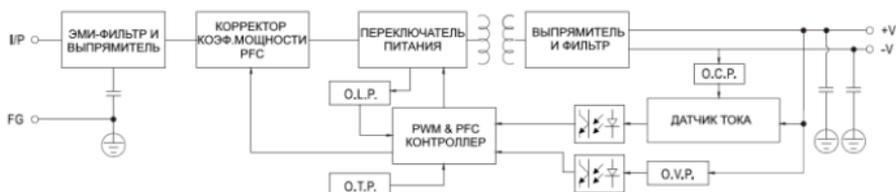
Рисунок 4. Принципиальная схема блока питания.
