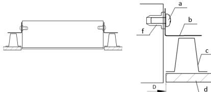
3. Снять решетку, проложить сетевые провода через отверстие в корпусе.
