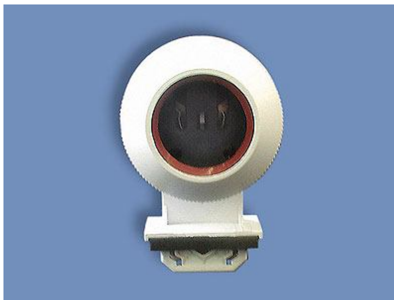
Патрон (ламподержатель) герметичный G13 для люминесцентных ламп T8, одиночный IP67 (водо- и пылезащищенный) с прижимной муфтой под лампу Ø 26мм в сборе (крепление на защелки), серый
