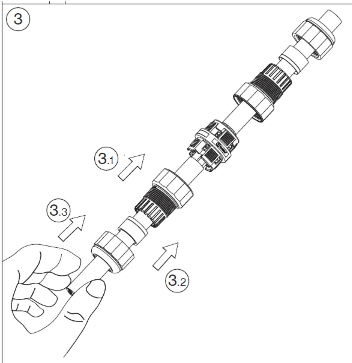
Для окончательной затяжки рекомендуется использовать специальный инструмент.
