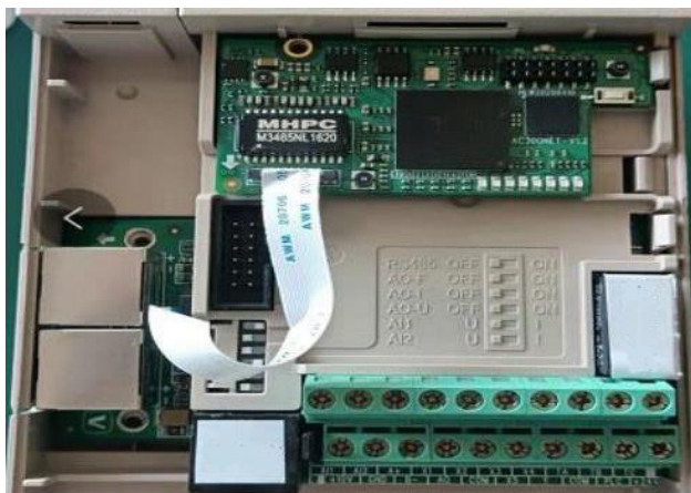
Рис. 7.2 Вариант установки на преобразователях частоты мощностью 2.2кВт-5.5кВт
