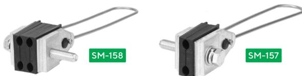
Корпус зажима изготовлен из алюминиевого сплава, плашки – из пластмассы. Скобы зажимов изготовлены из нержавеющей стали со съемными креплениями на обоих концах для удобства монтажа.
