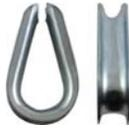
Изготовлен из стали, покрытие - Белый цинк. Применяется в различных грузоподъемных устройствах, а также предназначен для установки на трос (канат), при создании петли, предохраняя его от перетирания.
