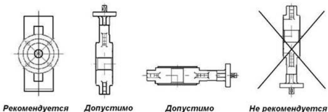
Предпочтительно устанавливать затвор так, чтобы шток располагался горизонтально, а нижняя часть диска при открытии затвора двигалась по направлению движения рабочей жидкости (особенно в случае установки на среды с большой плотностью или вязкостью).
