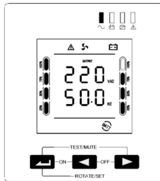
Рис. 9. Экран с кнопками управления ИБП
