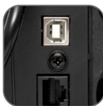
Встроенный порт удаленного мониторинга режимов работы ИБП
