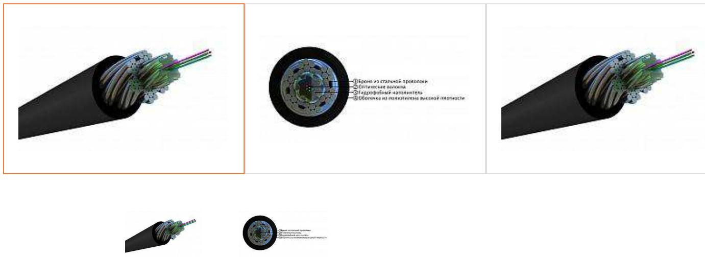
Hyperline FO-AWS2-OUT-504-4-PE-BK Кабель волоконно-оптический 50/125 (OM4) многомодовый, 4 волокна, гибкий, бронированный, волокна в канате из стальных проволок, гелезаполненный, внешний, PE, черный
