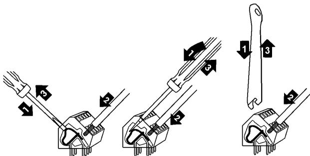
Для подключения проводников в клеммы:
