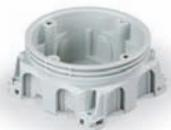
Распределительная коробка AU19 имеет 8 вводов с удаляемой мембраной по сторонам и 4 на дне. Коробка может быть закреплена по бокам гвоздями или опорами PMR577. Возможна установка в узких пространствах (глубиной 47 мм, такой же, как и глубина самой коробки).
