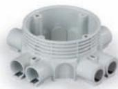
Распределительная коробка AU8 высотой 53 мм имеет 8 ответвлений, 2 для фитингов Ø 16 и 6 для Ø 20. Два отверстия Ø 20 снабжены съемными редукторами, позволяющими использовать их для вводов Ø 16. Коробка также имеет 4 ввода с удаляемой мембраной по сторонам и 4 на дне. Коробка может быть закреплена по бокам гвоздями.
