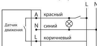
Рисунок 11. Схема с добавлением настенного выключателя в цепь для ручного подключения нагрузки
